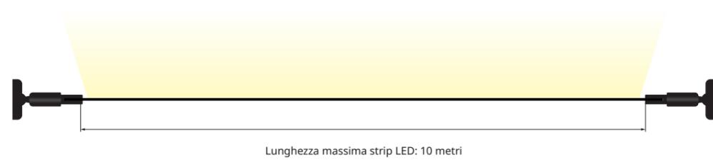
Per installare la strip LED nel profilo aereo è necessario ordinare il kit di installazione + la piastra di dissipazione a misura (CM).
