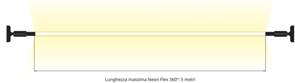
Per installare la Neon Flex 360° nel profilo aereo è necessario ordinare il kit di installazione + 2 pzz. dell'accessorio per Neon Flex 360°.
